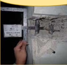
鉄筋径計測
